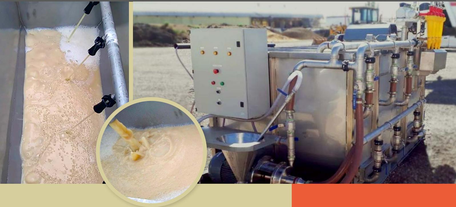
La **UCS 3.0 AI** está construida en **Acero Inoxidable AISI 316** lo cual la vuelve adecuada para cualquier tipo de uso y fluidos. Esta unidad cuenta con 3 tanques, cada uno con inyectores, pudiendo manejar un **volumen total de hasta 3.800 litros**, un colector de montaje de hidrociclones, un **mezclador MAREF M2** construido también en acero inoxidable AISI 316 y todas las válvulas y tuberías necesarias para crear un sistema de mezclado suave y sin esfuerzo.
